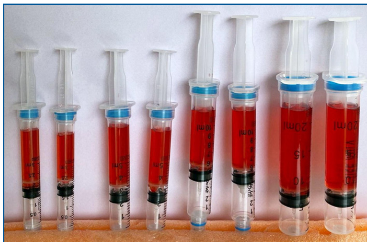
Figura 2: Teste de vedação da borracha de ajuste do êmbolo das seringas por drenagem gravitacional. Vitória, ES, Brasil, 2025. Fonte: Elaborada pelo autor.
